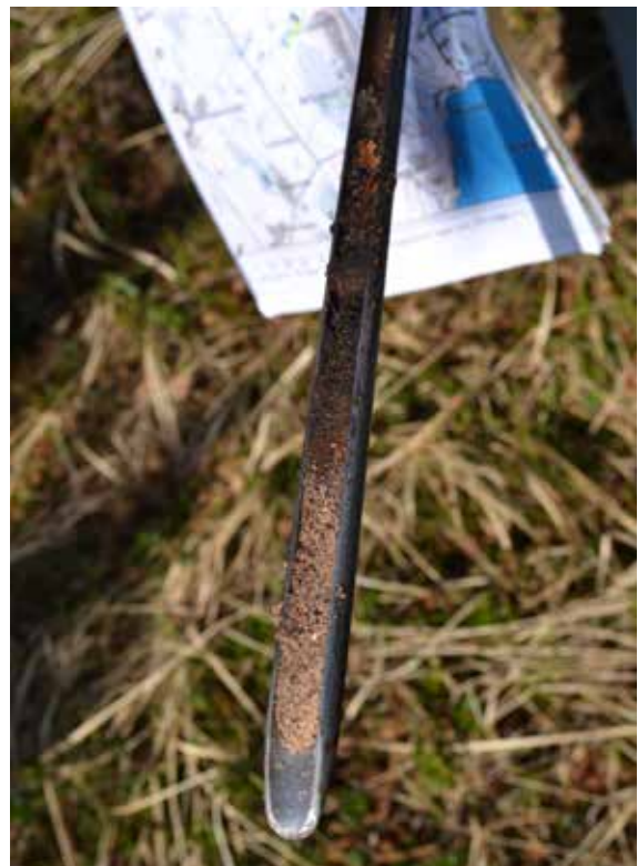
Kuva 8. Valuma-alueen maalajia ja turpeen paksuutta selvitetään maaperäkairan avulla. Kuva: Sanna Tikander
