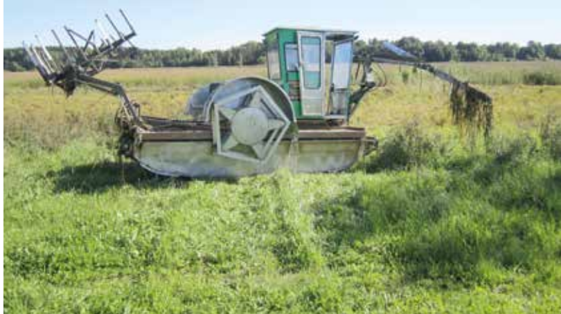
Saarenjärven vesikasvillisuuden leikkuutyöt tehtiin Truxor-merkkisillä koneilla. Leikkumassat sijoitetaan kompostointin jälkeen läheiseen peltoon maanparanteeksi. Kuva: Pasi Salmi
