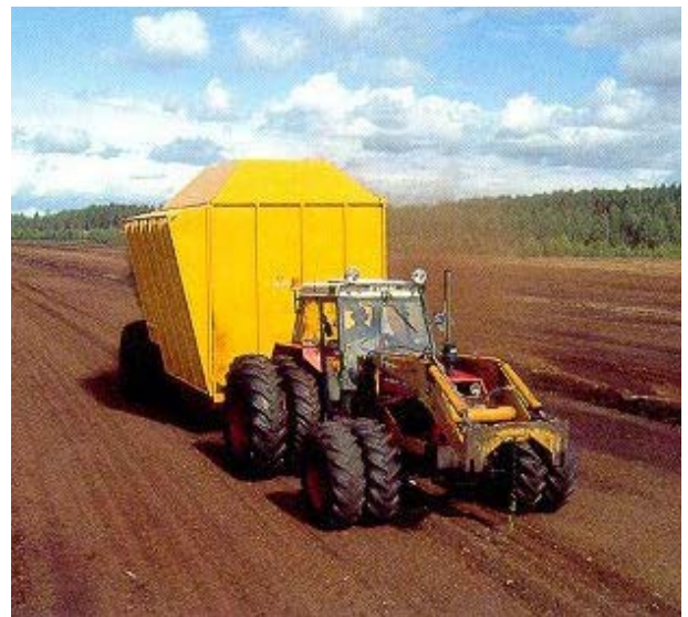
Kuva 6. Kuivaa pintaturvetta kerätään koneellisesti. Kuva: Heikki Kokkonen
