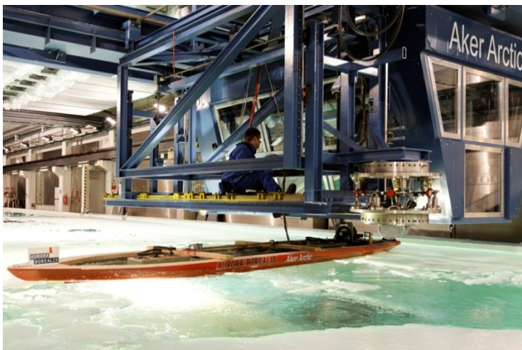
Kuva 1. Aker Arcticin jäämallilaboratorio Helsingin Vuosaarella. Kuvassa testataan Aurora Borealis -laivan mallia Aker Arctic Technology Oy:n jäälaboratoriossa Helsingin Vuosaarella. Kuvan lähde http://www.akerarctic.fi/ http://www.eri-aurora-borealis.eu/ // Myllylä 2010a.
