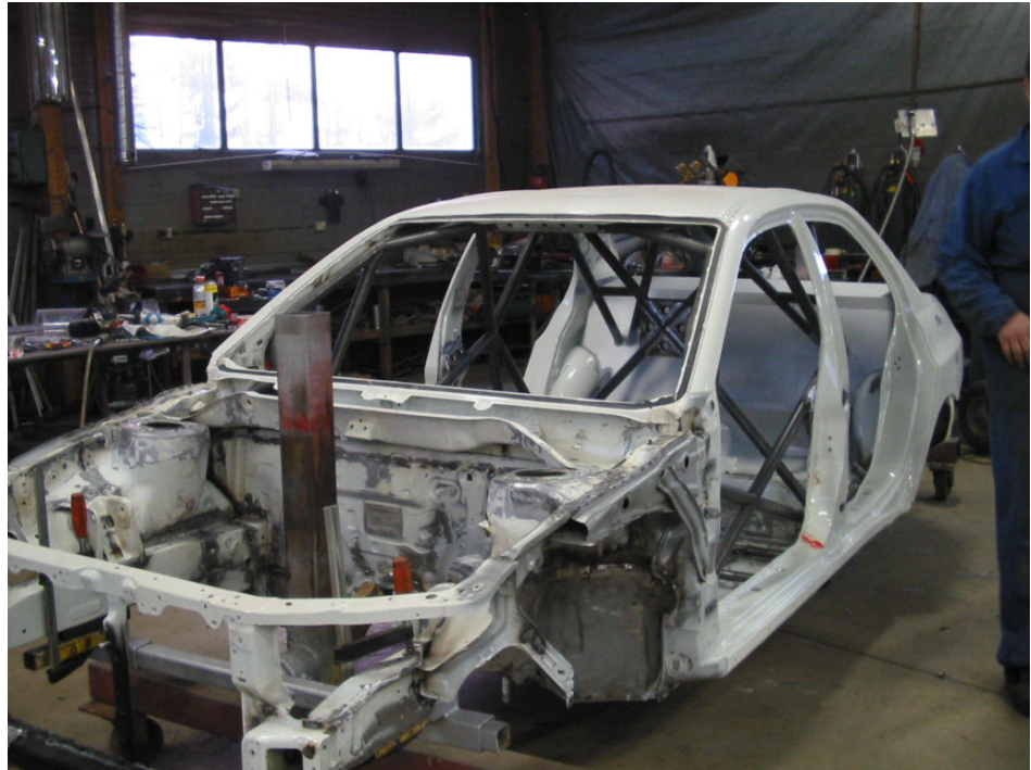
Kuva 3. Kori valmina maalattavaksi
