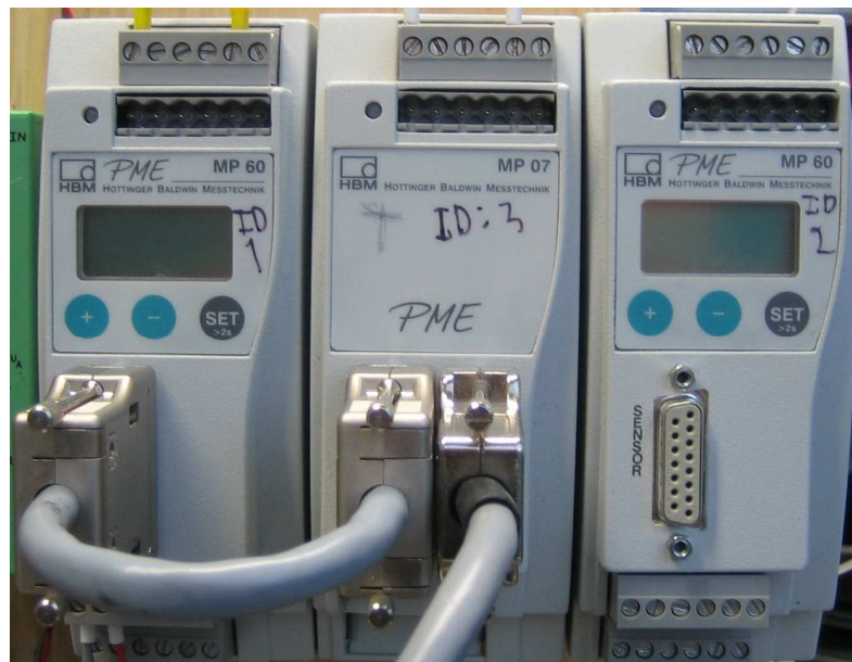
Kuva 9. HBM:n MP60- ja MP07-moduulit; keskeltä lähtevä johto menee T32FNA-momenttianturille, joka voidaan kalibroida MP60-moduulin etupaneelin kautta
