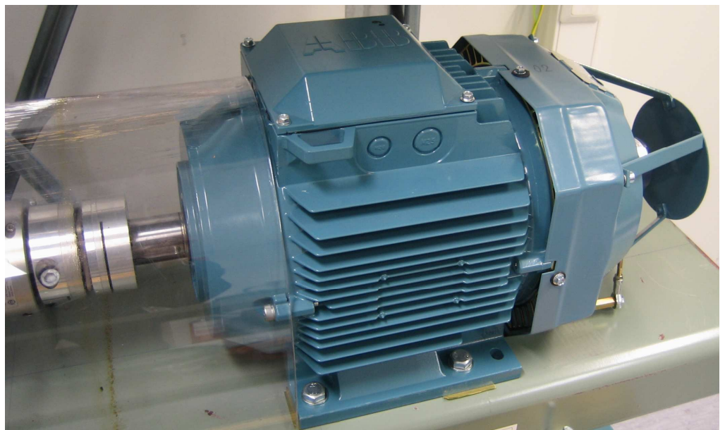
Kuva 4. Kolmivaiheinen oikosulkumoottori, jonka nimellisteho on 7,5 kW; akselille on kiinnitetty kuorma
