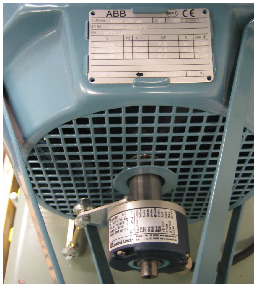
Kuva 6. Etualalla moottorin akseliin kiinnitetty Leine & Lindlen inkrementtianturi
