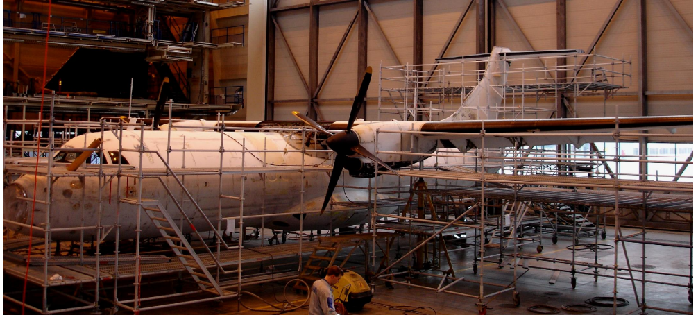
Kuva 8. ATR-42 -lentokone telakoituna purettavilla huoltotelakoilla.
