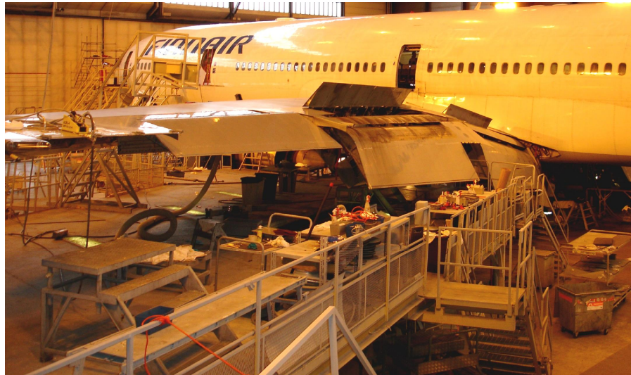
Kuva 7. MD11-lentokoneen siiven kiinteä huoltotelakka.
