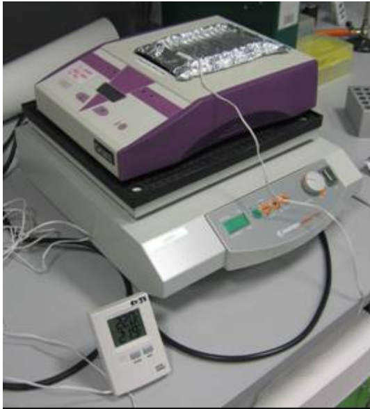
Lämpötiloja mitattiin digitaalisella mittarilla foliokaivoista.
