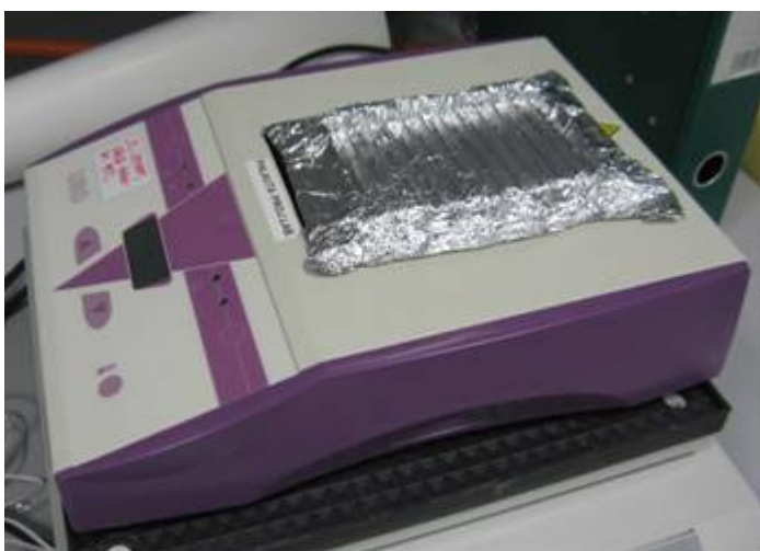
Foliosta muotoiltiin foliokaivot näytekaivoja varten lämpöblokkien päälle.
