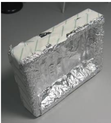
Styroksilevyistä ja foliosta tehtiin kaivojen päälle kansi.
