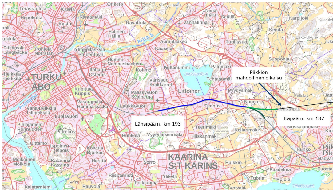
Kuva 35. Kupittaaan itäpuolelta Littoisten itäpuolelle ulottuva likimääräinen kaksoisraiteen sijainti on esitetty kuvassa. Kaksoisraideosuuden itäpää on esitetty nykyistä linjaus pitkin (tumman vihreä) ja Piikkiön oikaisun linjausta pitkin (vaaleampi vihreä).
