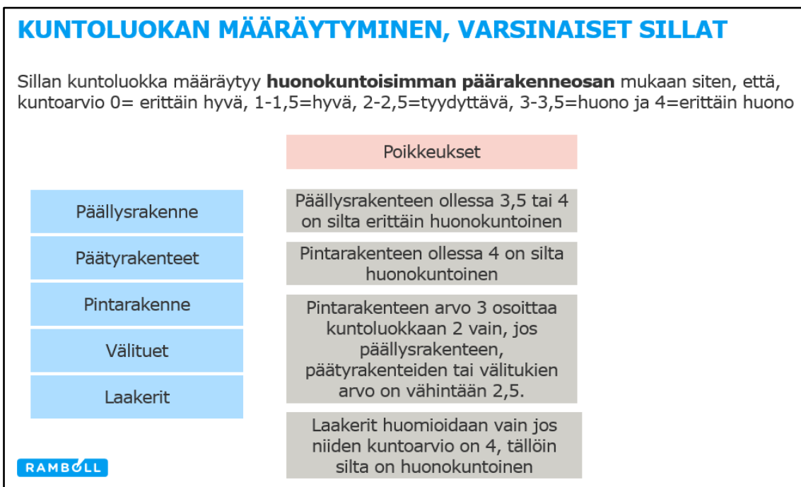
Kuva 29. Kuntoluokan (rakenteellinen kunto) määräytyminen varsinaisilla silloilla.
