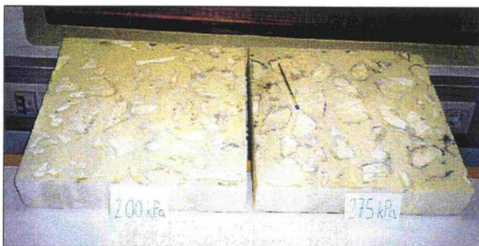
Kuva 14. Kuormituskokeissa sepelirakeista routalevyihin muodostuneet painumajäljet (Nurmikolu & Kolisoja 2001).
