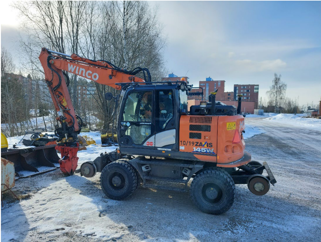
Kuva 3. Kiskopyöräkaivinkone (Kuva: Martta Viljanen, 30.3.2022).
