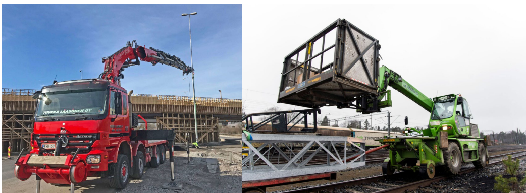
Kuva 5. Nosturiauto, jossa kiskopyörävarustus (Kuva: Tuukkalaasonen.fi) ja kiskopyöränosturi eli Merlo (Kuva: jopaline.fi).
