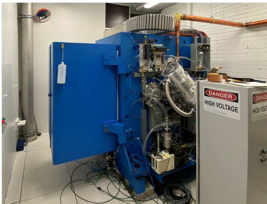
Fig. 1. Den medicinska cyklotronen TR-19. Den blåa utbuktningen på vänster sida är neutronskyddet kring målstation 1.
