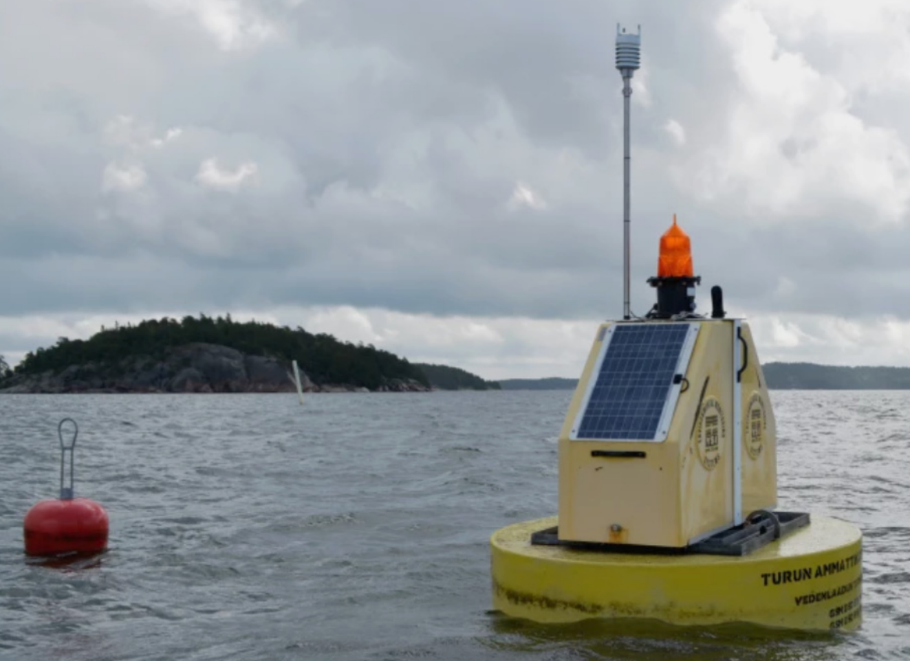
Den profilerande bojen vid Päiväluoto mätstation nära Själö.
