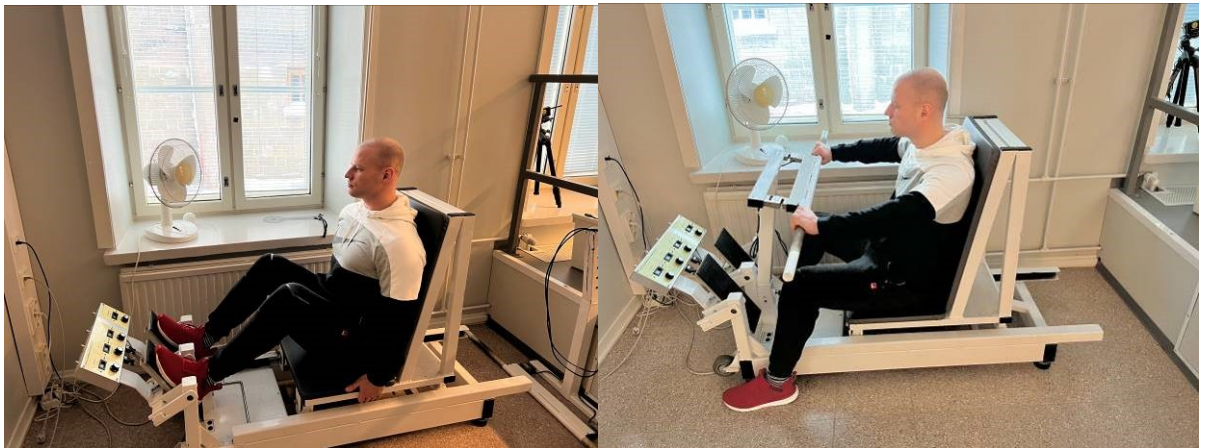
Kuva 8 Ala- ja yläraajojen bilateraalin maksimaalisen isometrisen voiman dynamometri
