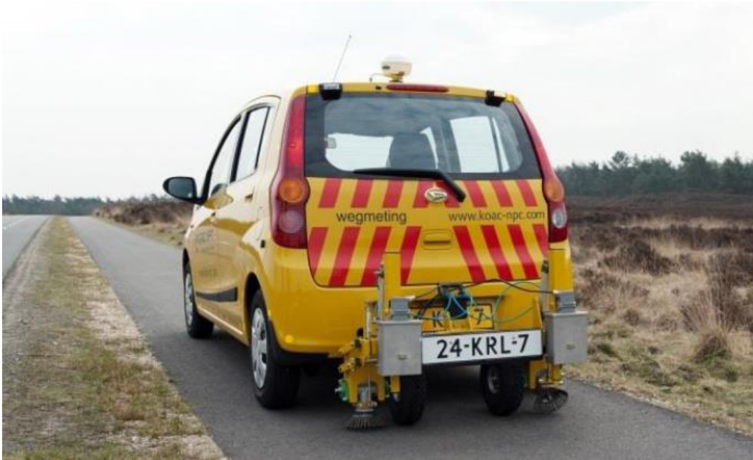
Kuva 7. Alankomaissa käytetty pyöräilijän mukavuusmittari Cycle Comfort Meter 33 .
