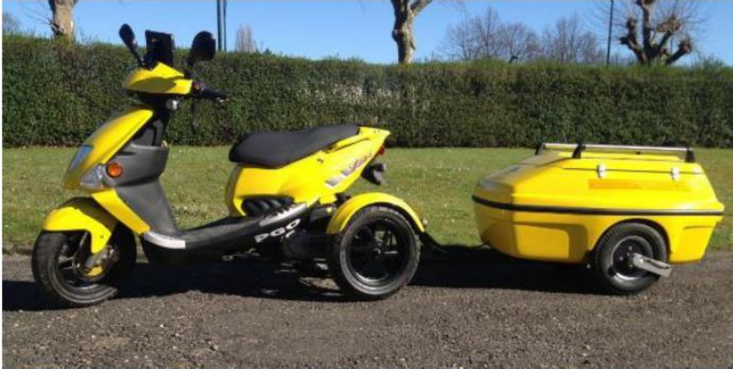
Kuva 5. Pyörätien profiilin mittauslaite (Cycle track profilometer) 32 .
