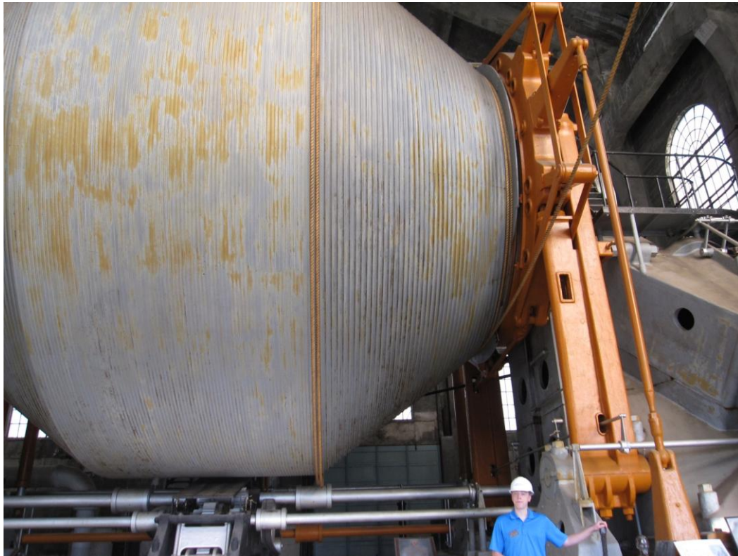
Köysirumpu, jolla malmi nostettiin kuilusta
