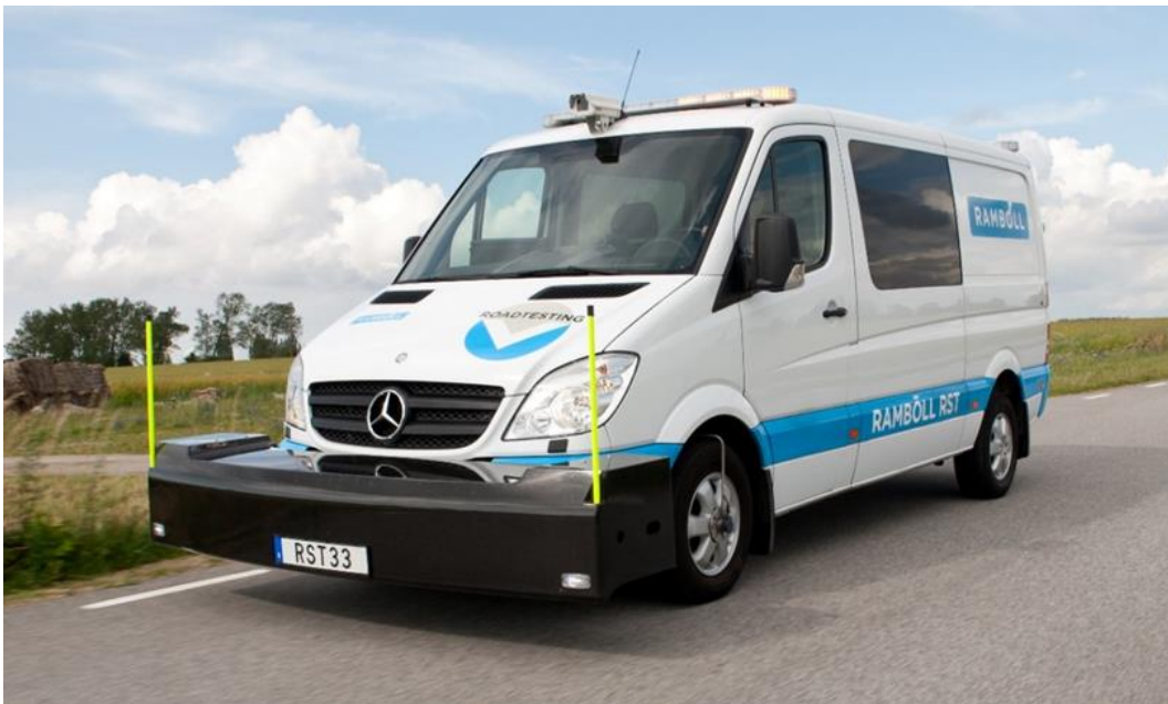
Kuva 1. Pistelasertekniikkaa käyttävä PTM-mittausauto.
