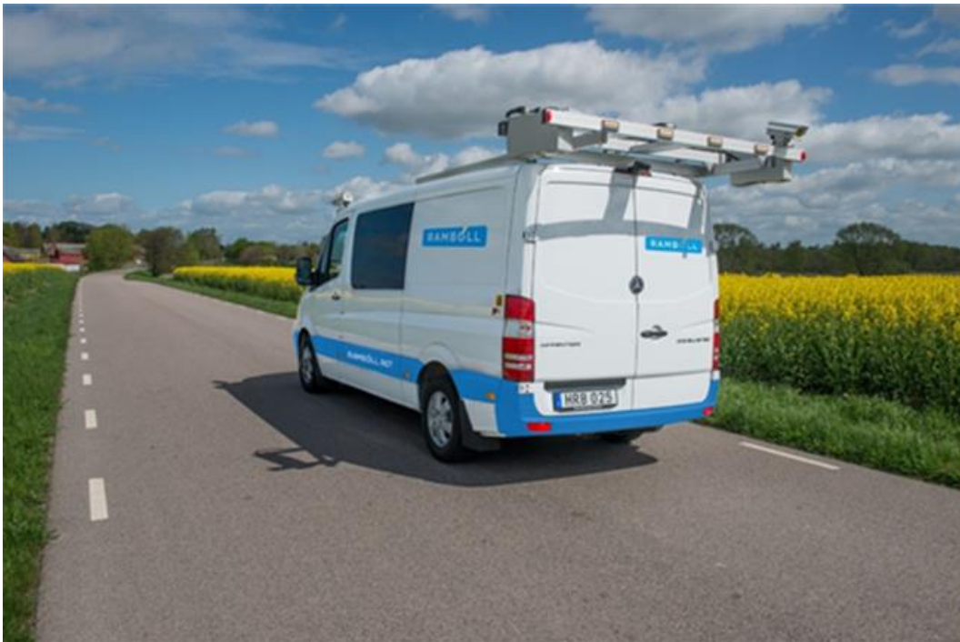
Kuva 3. 3D-laserskannaukseen perustuva päällysteskaneri.
