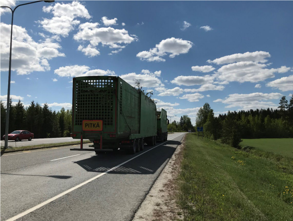
Kuva 3–3. Valvontapaikkojen mitoitusajoneuvo on HCT-yhdistelmä (pituus 34,5 m). (Kuva: Piritta Laitakari)
