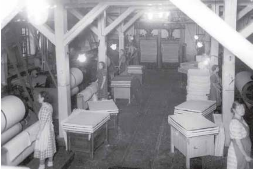
Pahviarkit leikattiin kokoojakoneen sylinteriltä katajaisella kepillä. Ohuimpiin laatuihin käytettiin metalliveistä. Kokoojakonesalin perällä sijaittivat prässit, joissa määristä arkeista puristettiin mahdollisimman paljon vettä pois. Kuva: Verlan tehtaan arkisto.
