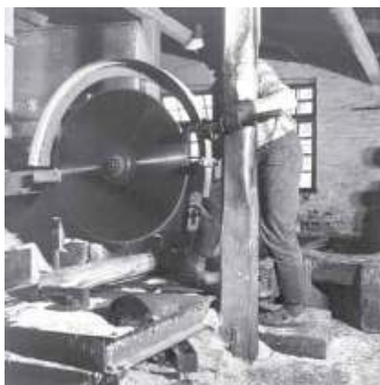
Puut sahattiin ensin pölleiksi ja sitten niistä kuorittiin tumma pintakerros kuorimakoneella. Kuvat 1960-luvulta, Verlan tehtaan arkisto.
