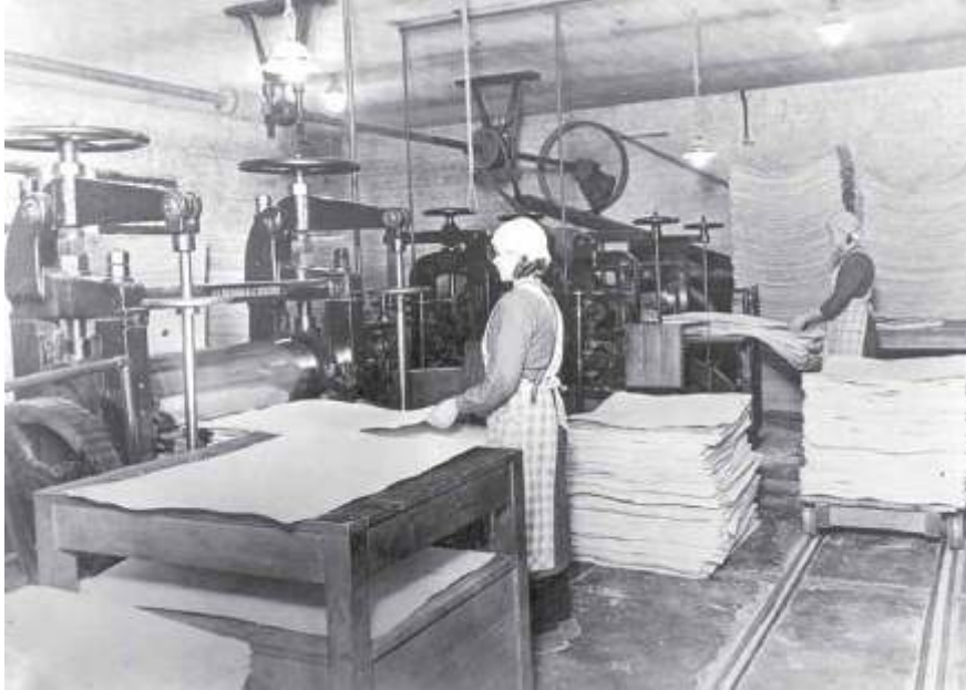
Pahviarkit laskettiin yksitellen läpi kiillotuskoneista. Arkkipinoja liikutettiin tehtaalla pienien vaunujen avulla (oik.). Kuva: Verlan tehtaan arkisto.
