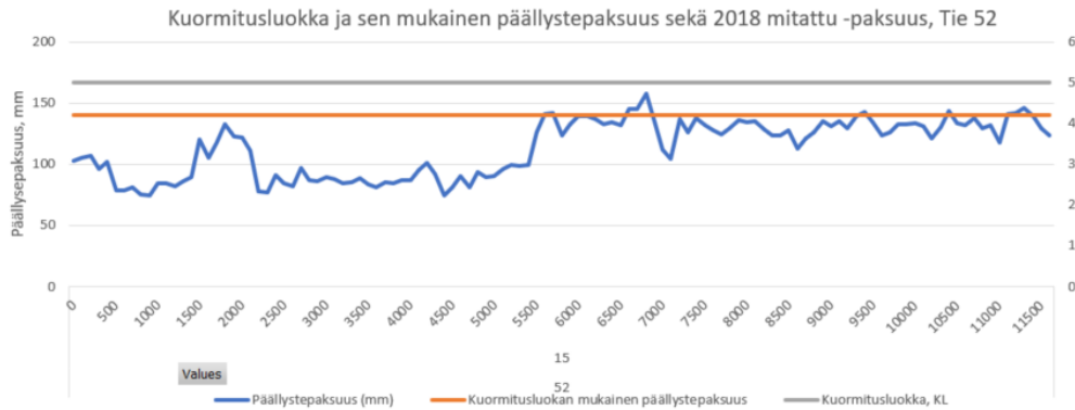
Kuva 7. Päällystepaksuudet (tavoite ja mittaus 2018) ja kuormitusluokka tie 52.
