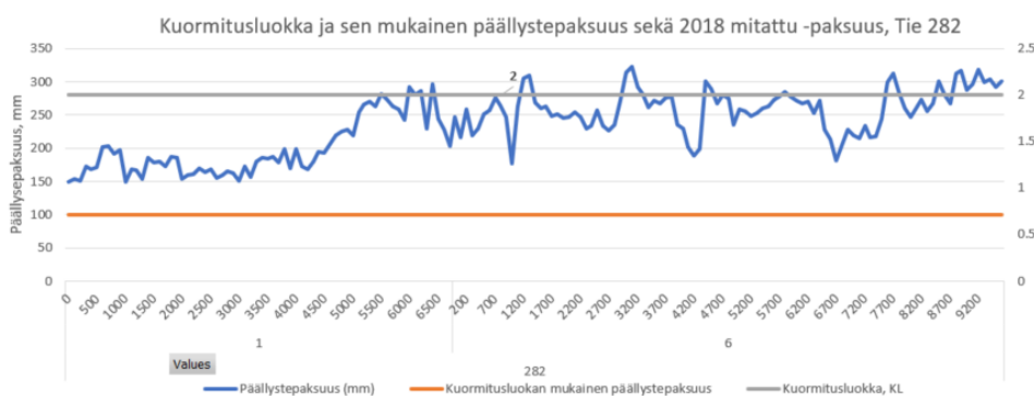
Kuva 8. Päällystepaksuudet (tavoite ja mittaus 2018) ja kuormitusluokka tie 282.
