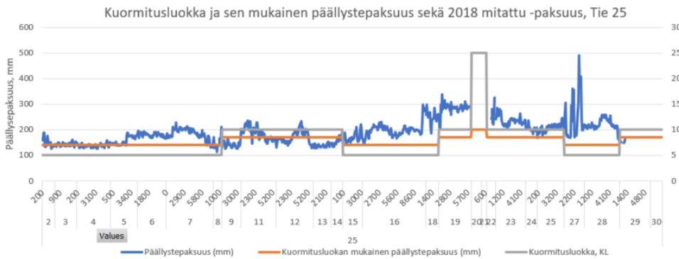
Kuva 5. Päällystepaksuudet (tavoite ja mittaus 2018) ja kuormitusluokka tie 25.
