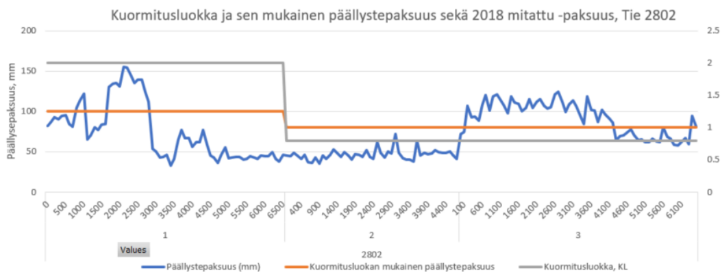
Kuva 9. Päällystepaksuudet (tavoite ja mittaus 2018) ja kuormitusluokka tie 2802.
