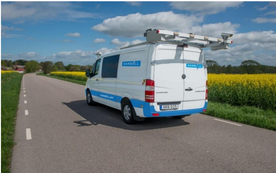
Kuva 1. Rambollin 3D päällysteskanneri PTM mittauksiin.
