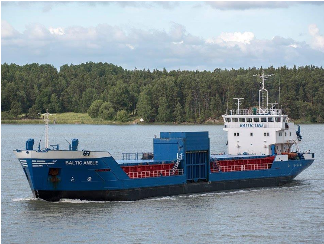
Kuva 9. RABN-varustamon Saimaa-kokoluokan alus, jonka leveys on 12,5 m, pituus 82,4 m ja maksimisyväys 5,2 m. Aluksen jääluokka on 1B. (kuva: RABN)
