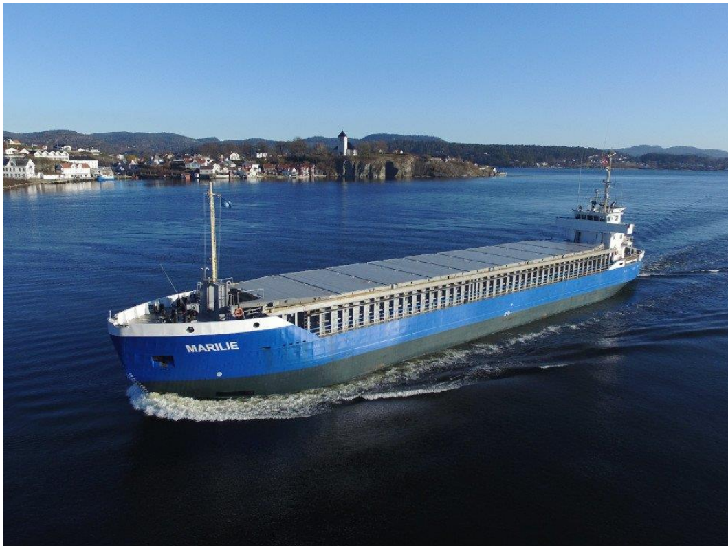
Kuva 11. Prima Shipping -varustamon alus, jonka leveys on 12,5 m, pituus 88,0 m, ja syväys 5,3 m. Aluksella voidaan liikennöidä Saimaan kanavassa, jos sulut pidennetään. Aluksen jääluokka on 1B. (kuva: Prima Shipping)
