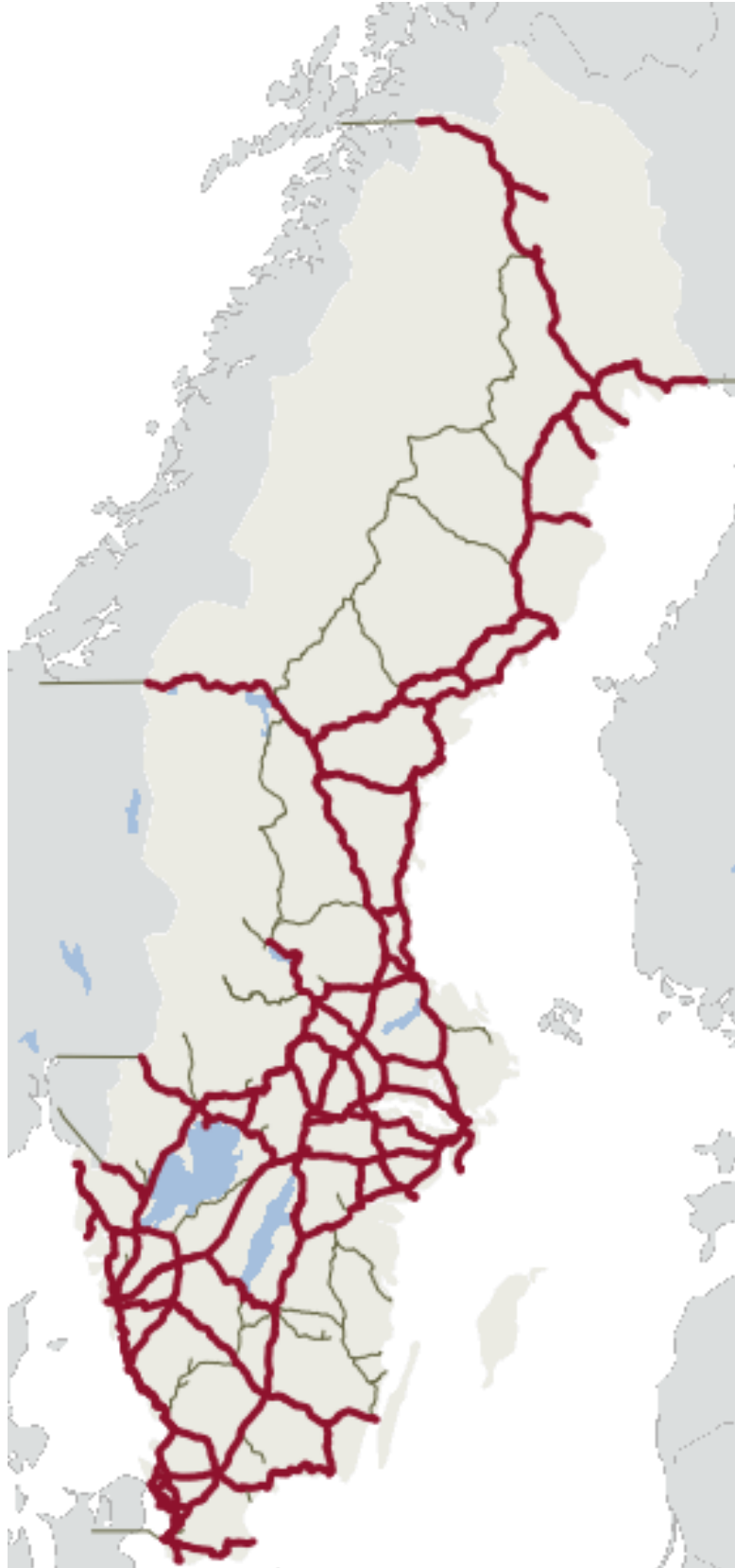
Kuva 4. Sähköistetyt rataosat Ruotsissa. (lähde: Järnvägsnätsbeskrivning 2020, https://jnbkarta.trafikverket.se/?year=2020 )
