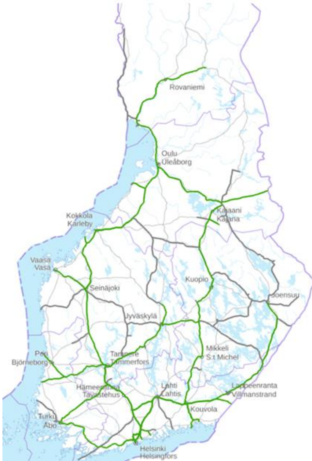
Kuva 3. Sähköistetyt rataosat Suomessa. Sähköistetyt rataosuudet esitetty vihreällä. (lähde: Verkkoselostus). Käynnissä olevia sähköistyshankkeita ovat Turku–Uusikaupunki, Pori–Mäntyluoto–Tahkoluoto, Hyvinkää–Hanko ja Iisalmi–Ylivieska-sähköistykset (suunnittelu/toteutus).
