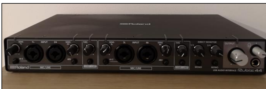
Kuva 3.2 Tutkimuksessa käytetty äänikortti Roland Rubix 44.
