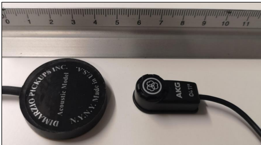
Kuva 3.1 Tutkimuksessa käytetyt kontaktimikrofonit. Vasemmalla DiMarzio DP130BK ja oikealla AKG C411.
