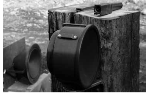
■ Kylkimiina 87 kiinnityskiskolla pölkyn kylkeen asennettuna ja tähtäinputki poistettuna. Kuvan vasemmassa alareunassa häämöttää raskas kylkimiina 81 kuljetuslaatikkonsa päällä. Kuva: Mikko Sivonen.
