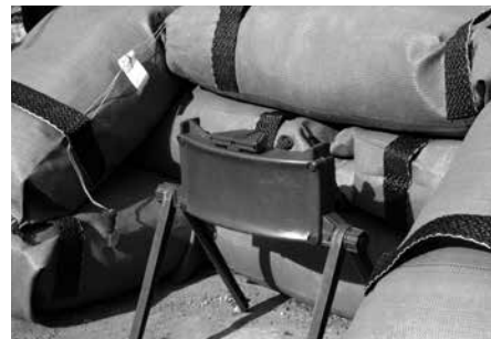
■ Kevyt viuhkamiina 88 asennettuna miinojen tehoesittelyä varten, kierretulppaan kiinnitetty sytytin vielä irti miinasta. Kuva: Mikko Sivonen.
