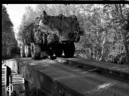
■ Silta-auto Sisu E15 TP-L:n laskeman Leguan-sillan pituus on 25 metriä. Kuvat: a, d ja e) Mikko Sivonen, b) KARPR/KYMPIONP ja c) Veli-Pekka Tikkanen.
