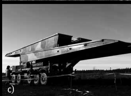
■ Silta-auto Sisu E15 TP-L:n laskeman Leguan-sillan pituus on 25 metriä. Kuvat: a, d ja e) Mikko Sivonen, b) KARPR/KYMPIONP ja c) Veli-Pekka Tikkanen.
