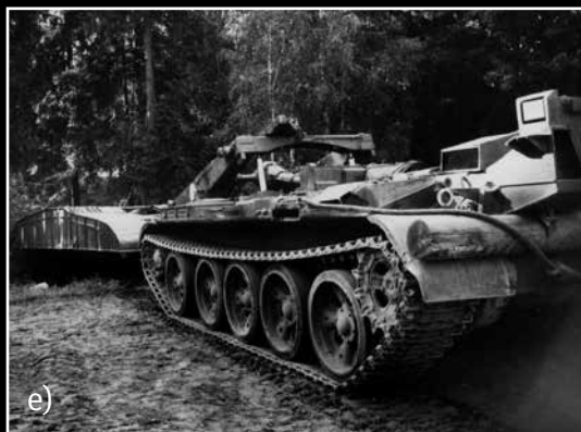
■ Panssariprikaateille hankittujen MTU-20 -siltapanssarivaunujen miehistöön kuului kolme panssaripioneeria. Panssarivaunun päällä taitettuna oleva silta ojennetaan täyteen pituuteensa ja työnnetään esteen ylitse. Kuvat: a ja c-f Museo Militaria, kuva b Sotamuseo.
