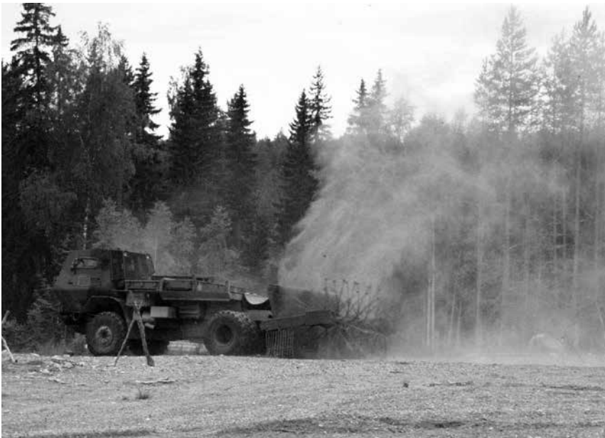
■ Raivaamisajoneuvo 92:n varstaraivain pyörii ja poistaa miinat. Kuva: Sotamuseo.
