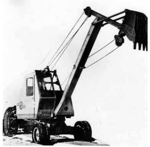
■ Pioneerijoukkojen sodan ajan joukkojen konekanta laajeni 1950-luvulla, mutta alku oli vaatimaton. Lisenssivalmisteinen Pikku-Jussi oli aikanaan yleisimpiä siviiliurakoitsijoiden työkoneita. Kuva: Sotamuseo.
