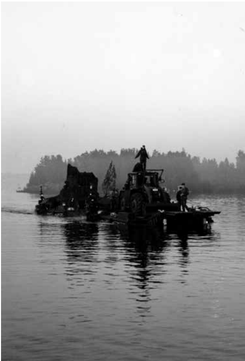
■ Prikaatinlautan käyttö suurlauttana. Toisiinsa kytkettyjen lauttojen kuormana ovat molempien lauttojen vetäjät. Kuva: Sotamuseo.
