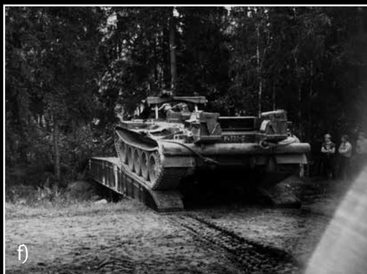
■ Panssariprikaateille hankittujen MTU-20 -siltapanssarivaunujen miehistöön kuului kolme panssaripioneeria. Panssarivaunun päällä taitettuna oleva silta ojennetaan täyteen pituuteensa ja työnnetään esteen ylitse. Kuvat: a ja c-f Museo Militaria, kuva b Sotamuseo.
