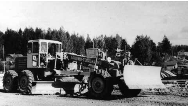
■ Vanhemmista ”köykkämalleista” siirryttiin 1950-luvulla katettuihin tiekarhuihin. Lokomon Teräskarhun vanhemmat mallit hallitsivat 1950-luvun puolivälistä alkaen markkinoita. Kuvan malli on 1960-luvulta. Kuva: Sotamuseo.
