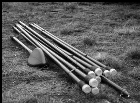
■ Putkiraivain 95 on edeltäjästään poiketen muovirunkoinen. Kuva: Veli-Pekka Tikkanen.
