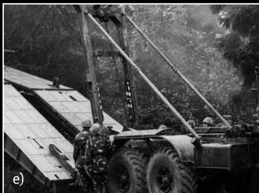
■ Panssariprikaatille hankittujen TMM-3- ja TMM-3M -silta-autojen kuoppasiltakalustoja voitiin laskea peräkkäin ja yhdistää toisiinsa, jolloin saatiin aikaan leveämmän esteen ylittämisen mahdollistava silta. Kuvat: a-c Sotamuseo ja kuvat d-e Museo Militaria.
