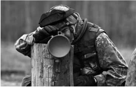
■ Kylkimiina 87 asennettiin pakkauksessa mukana tulleilla välineillä kantaan tai kasvavan puun kylkeen. Miinan tähtäysputki helpotti kohdistamista. Kuva: Veli-Pekka Tikkanen.
