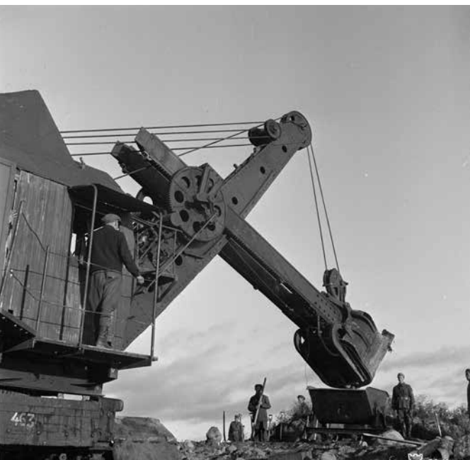
■ Puna-armeijalta sotasaaliiksi saatu raskas kaivukone Taipaleessa 14.10.1942. Ensimmäisten kotimaisten kaivukonemallien mukaisesti myös sotasaaliskoneet saivat lempinimen Hullu-Jussi. Kuva: SA-kuva.
