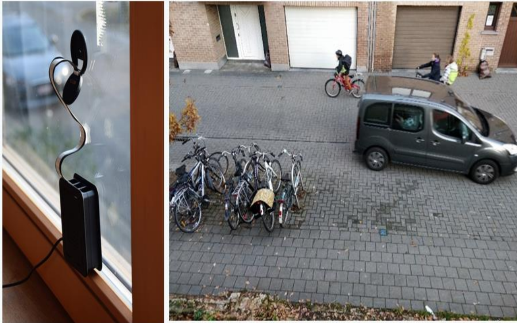
Kuva 19. Esimerkillinen Telraam-asennus näkymineen (telraam.com).
