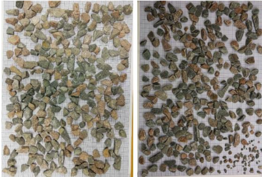
Kuva 42. Näyte C1 ennen kuulamylykoetta vasemmalla ja kuulamylykokeen jälkeen oikealla. Näytteen kuulamylyarvo on 10,3 ja litteysluku on 11 (Niko Hietala 2018).
