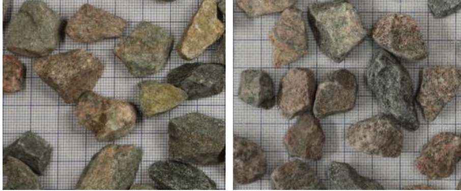
Kuva 48. Pintastruktuurin ja särmikkyuden muutoksia esihionnan seurauksena. Vasemmalla esihiomatonta kiviainesta ja oikealla 30 minuuttia esihiottua kiviainesta (Niko Hietala 2019).
