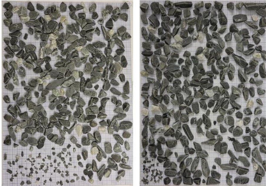
Kuva 47. Näytteen B1 kiviainekset kuulamylykokeiden jälkeen. Vasemmalla esihiomattoman kiviaineksen kuulamylynäyte ja oikealla 30 minuuttia esihiotun kiviaineksen kuulamylynäyte kokeen jälkeen. Vasemman näytteen kuulamylyarvo on 10,3 ja oikean näytteen kuulamylyarvo on 7,5 (Niko Hietala 2019).
