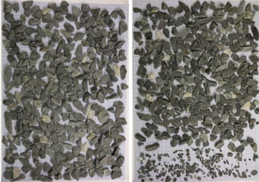
Kuva 39. Näyte B1 ennen kuulamylykoetta vasemmalla ja kuulamylykokeen jälkeen oikealla. Näytteen kuulamylyarvo on 12,8 ja litteysluku on 32 (Niko Hietala 2018).
