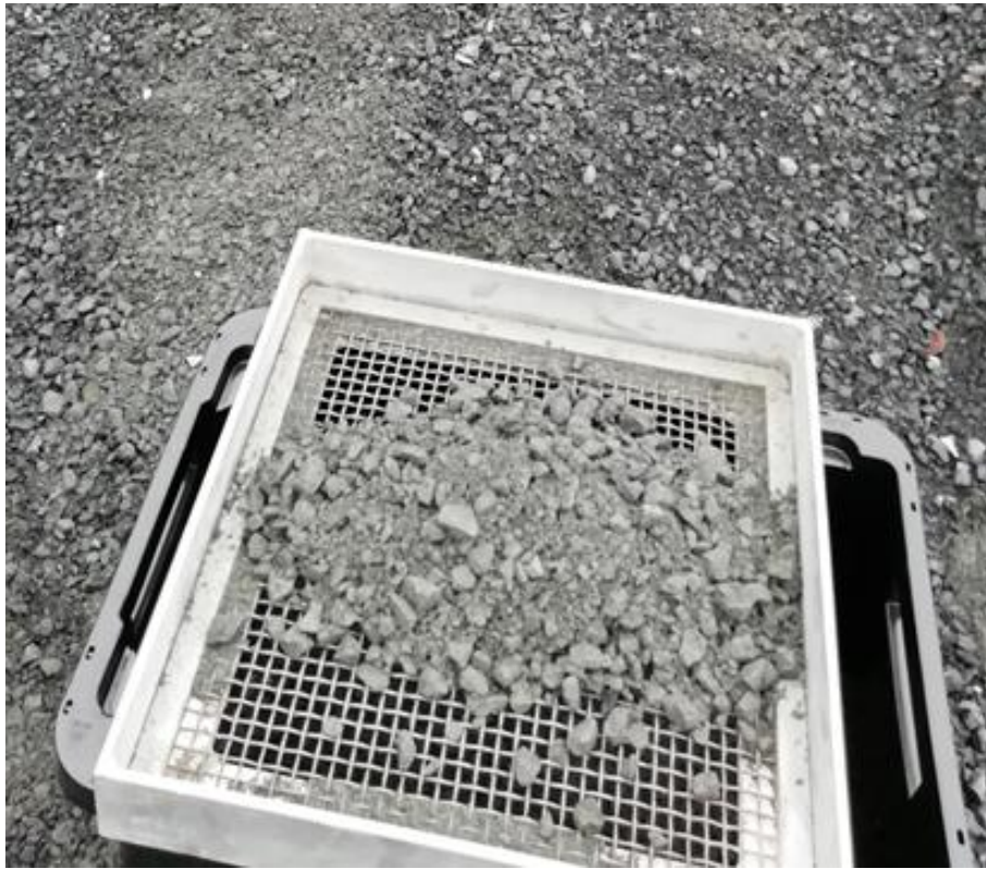
Kuva 29. Näytteen seulontaa D louhoksella lajitteen 0/16 mm varastokasasta (Niko Hietala 2018).
