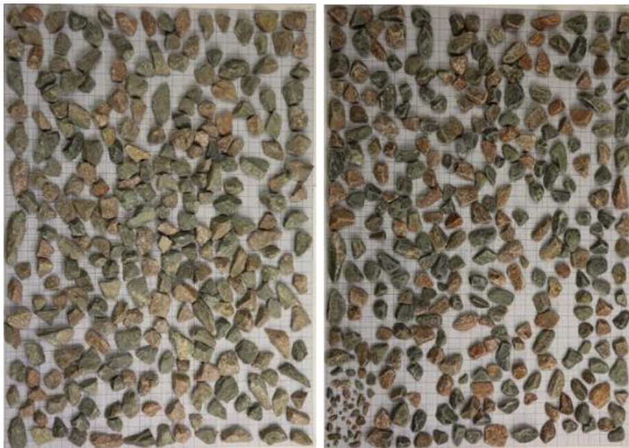
Kuva 43. Näyte C1 ennen kuulamylykoetta vasemmalla ja kuulamylykokeen jälkeen oikealla. Näytteen kuulamylyarvo on 10,1 ja litteysluku on 0 (Niko Hietala 2018).
