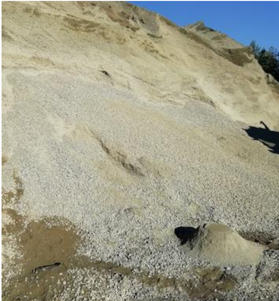
Kuva 28. Louhoksen C lajitteen 0/16 mm varastokasa (Niko Hietala 2018).
