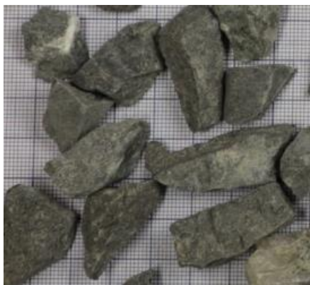
Kuva 46. Pintastruktuurin ja särmikkyuden muutoksia esihionnan seurauksena. Vasemmalla esihiomatonta kiviainesta B ja oikealla 30 minuuttia esihioittua kiviainesta (Niko Hietala 2019).
