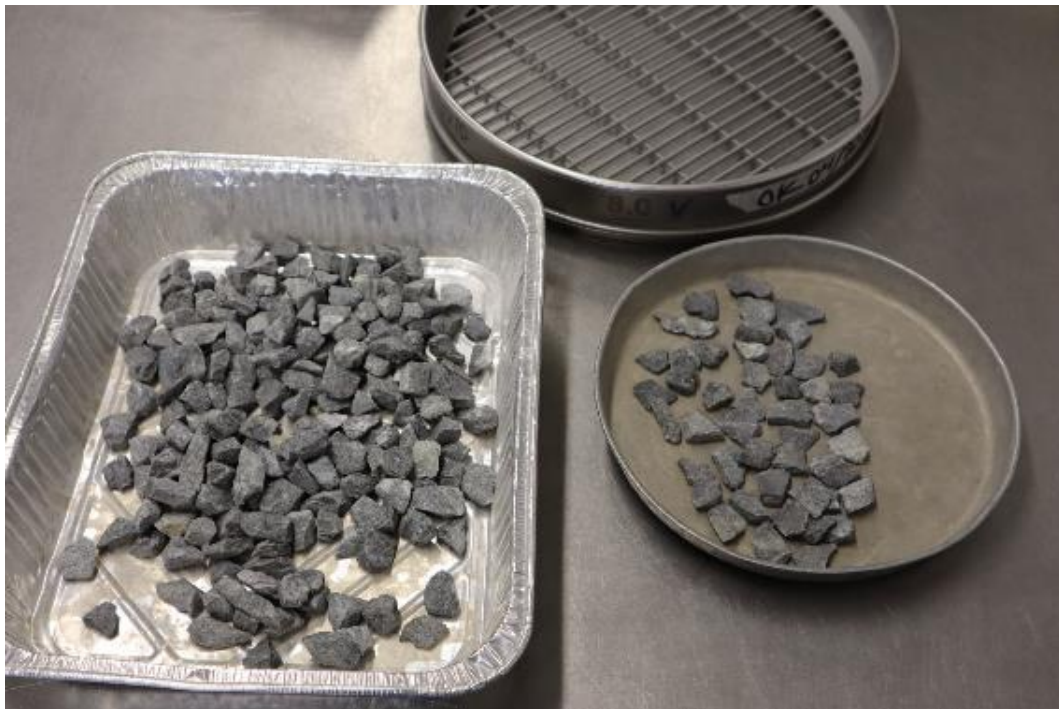
Kuva 32. Kiviaines lajiteltuna pyöreään ja litteään raemuotoon (Niko Hietala 2019).
