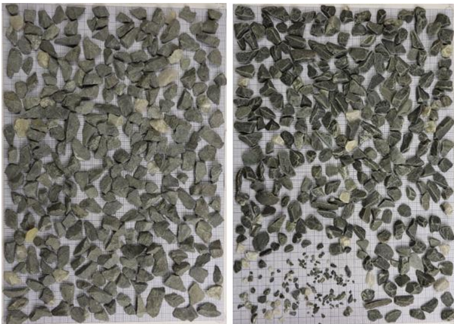
Kuva 40. Näyte B1 ennen kuulamylykoetta vasemmalla ja kuulamylykokeen jälkeen oikealla. Näytteen kuulamylyarvo on 9,7 ja litteysluku on 10 (Niko Hietala 2018).
