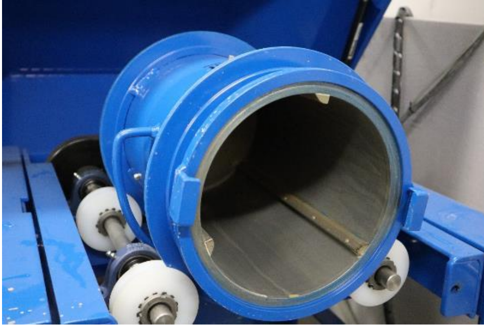
Kuva 33. Kuulamyllylaite (Niko Hietala 2019).
