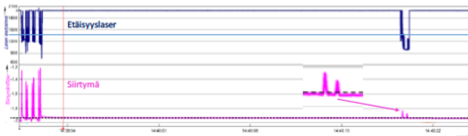
Kuva 103 Rekan ja RDSV-auton ylityksen aiheuttamat päällysteen alapinnan siirtymät ja ajoneuvojen sivuttaisetäisyydet etäisyyslaserilla mitattuna Simossa 27.4.2017. Mittauspäivän 7. oma kuormitus.
