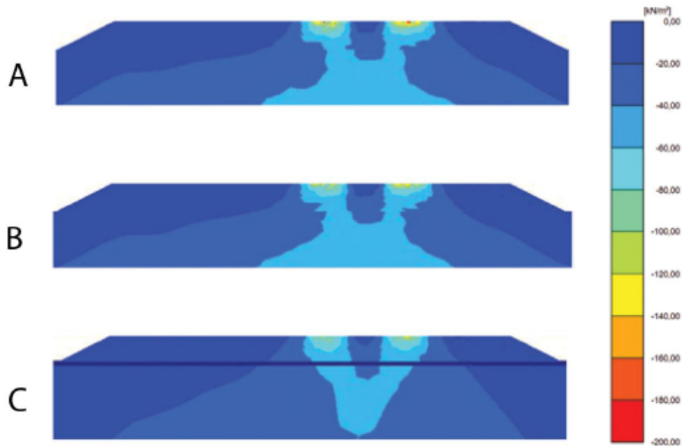
Kuva 128 Tierakenteessa vallitsevat pystyjännitystasot kuormitetussa rakenteessa. A: Simon koekohde, perustapaus, B: Simon koekohde, pohjamaan jäykkyys alennettu \frac{1}{2} alkuperäisestä ja C: Simon koekohde, rakennekerrokset vedellä kyllästyneessä tilassa ja pohjamaan jäykkyys laskentatapausta A vastaava.
