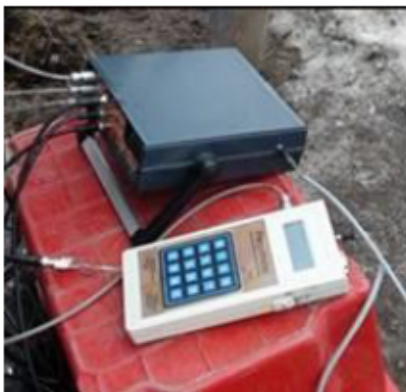
Kuva 1. Adek Ltd:n rakentama mittauslaite ja modifioitu Percometri nopeita mittauksia varten.
