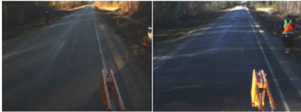
Kuva 37 Videon stillkuvat Percoaseman kohdalta eteenpäin ennen kuormituksia (vasen) ja kuormitusten jälkeen (oikea)
