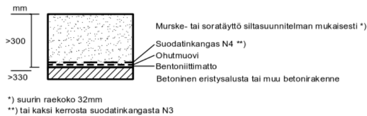
Kuva 26. Maakantisen holvisillan bentoniittimattosuojaus.
