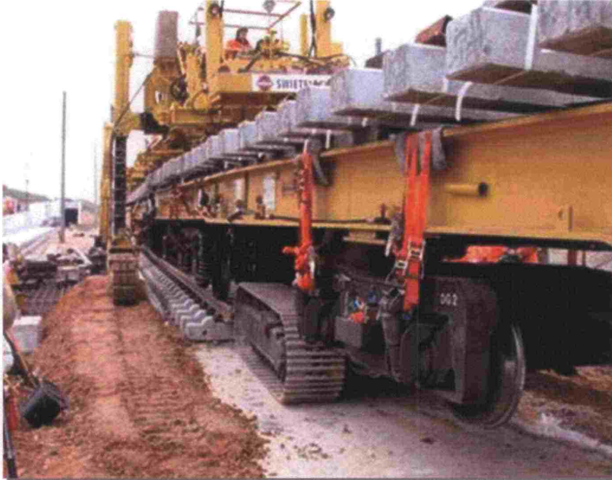
Kuva 17. Vaihteensiirto- ja asennuskone. (lähde: DB AG).
