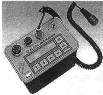
Kuva 3.1:8 Siirrettävän sondin yhteydessä käytettävä siirrettävä mittari.
