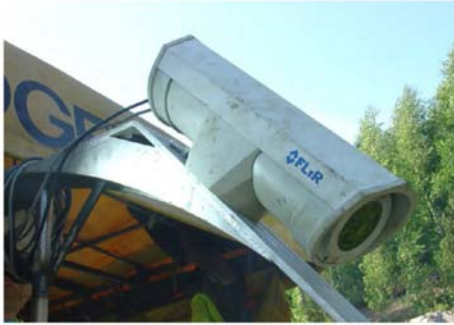
Kuva 8. Levittimen perään kiinnitetty lämpökamera (Nevalainen 2013).
