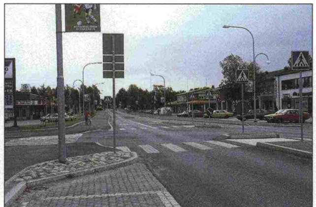
Kuva 4/14. Koulukadulla linja-autoaseman ympäristössä lähtökohta on ollut vaikea, koska rakennukset sijaitsivat niin kaukana tiestä, että ne eivät muodosta minkäänlaista katutilaa. Katutilan hahmotettavuutta on koetettu parantaa istuttamalla tien varteen korvaavia koivurivistöjä.
