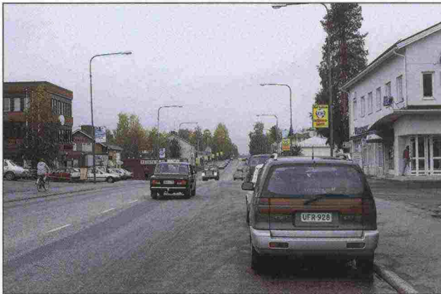
Kuva 4/22. Tienvarsipysäköinti on ohjattu taskuihin ja vino pysäköinti on ohjattu erilliselle pysäköintikaistalle.
