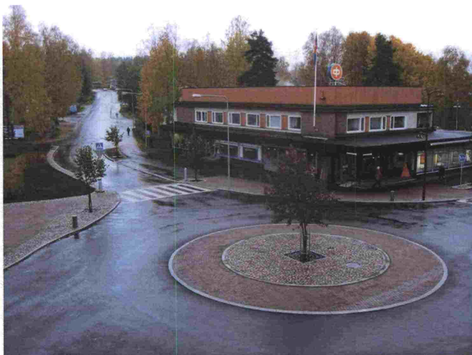
Kuva 5.3-2 Kiertoliittymä on turvallinen liittymämuoto.
