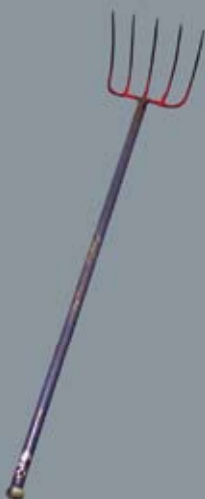
Pitkäpiikkinen hara soveltuu hyvin hakkuutähteiden poistoon lähteestä. Kuva: Veli Lyttikäinen.
