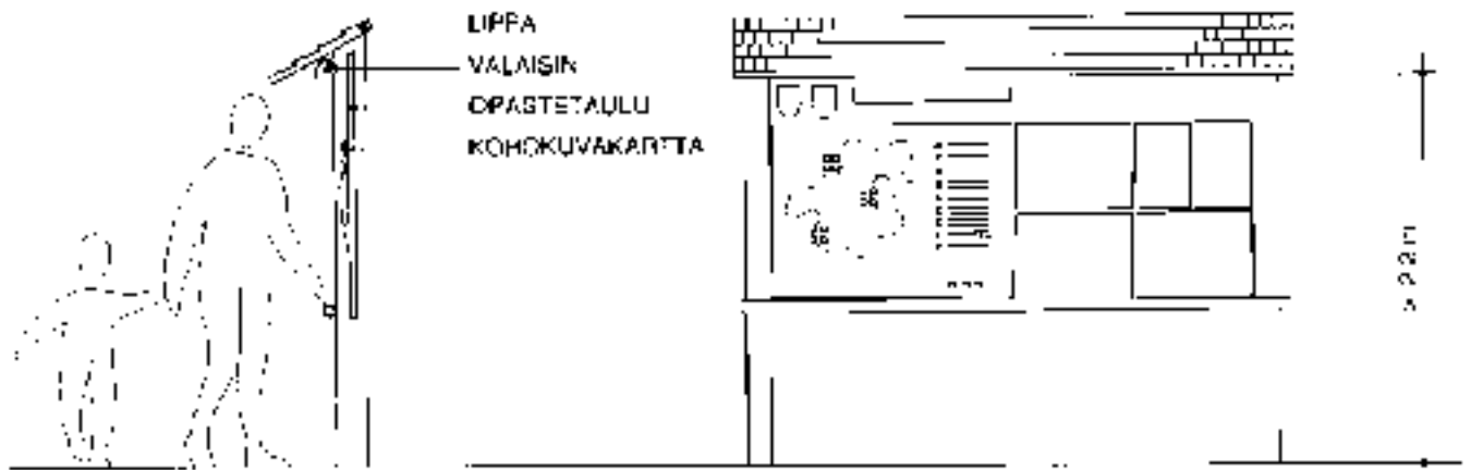
Periaatekuva opastaulusta 1:50. Lähde: Eeva Karjalainen, Irma Verhe. Ulkoilureitti, opas ulkoilureittien suunnittelijoille, rakentajille ja hoitajille. Suomen Latu 1995.
