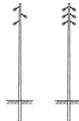
Päällystettyjen avojohdojen puupylväitä
