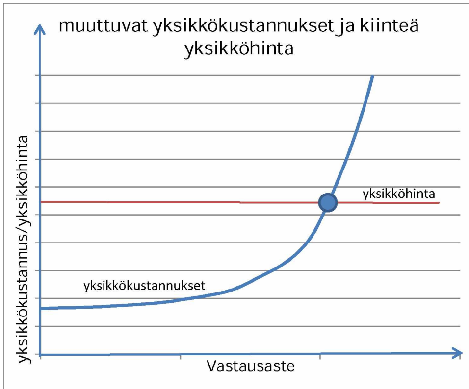
Kuva 19. Vastausasteen, muuttuvien yksikkökustannusten ja yksikköhinnan välinen periaatteellinen yhteys. Kun yksikkökustannukset ylittävät yksikköhinnan, ei vastausasteen nostaminen ole enää taloudellista.
