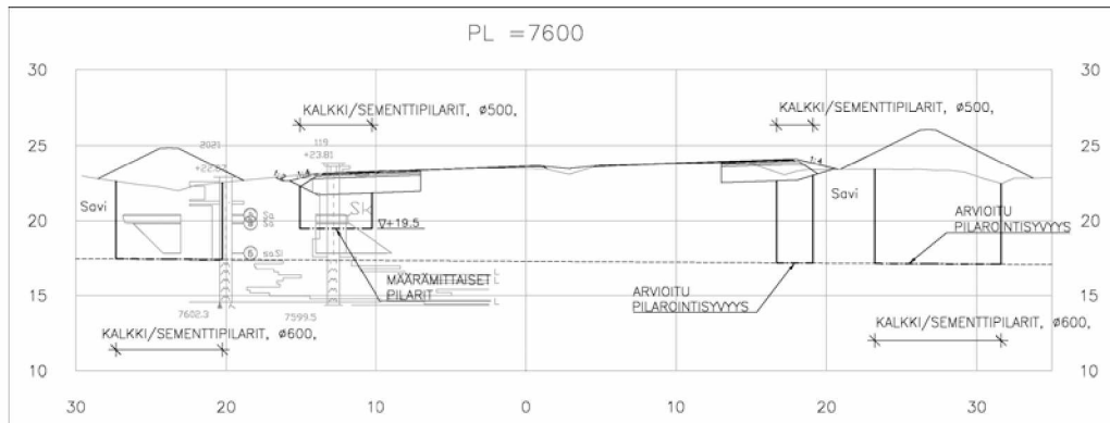
Kuva 13. Kehä I Vallikallion ja Vihdintien välillä, rakennettu n. 2010. Kehä I rakennettu 1970-luvun lopulla maanvaraisena. Eteläreunan levennys perustettu tavanomaiselle syvästabiloinnille (ajoradan kallistus keskikäistän suuntaan). Pohjoispuolen levennys perustettu määrämittaiselle syvästabiloinnille (kallistus ulospäin). Savikerroksen paksuus on siinä määrin suuri, että määrämittaisen stabiloinnin onnistumista ei pilannut pilarien tuleminen vahingossa painumattomiksi ja ainakaan ensimmäisten vuosien aikana ei ilmennyt haitallisen suurta painumanopeuden erilaisuutta.
