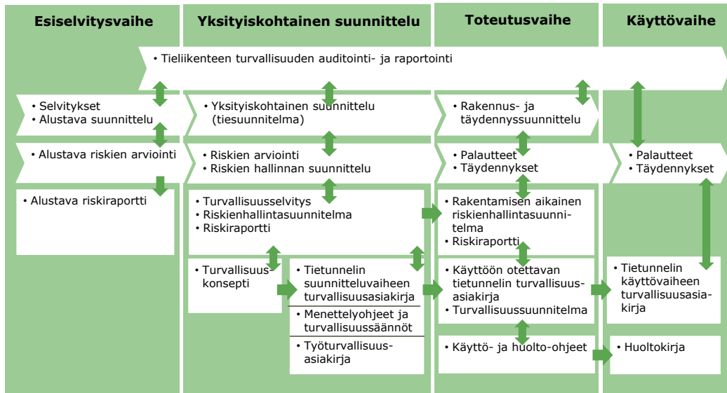
Kaavio 2. Tien päällerakentamisen riskienhallinta
